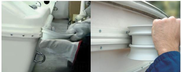
Il profilo esterno si monta completamente a freddo per le misure 30-40-52, tuttavia una notte in ambiente riscaldato favorirà l'operazione.
